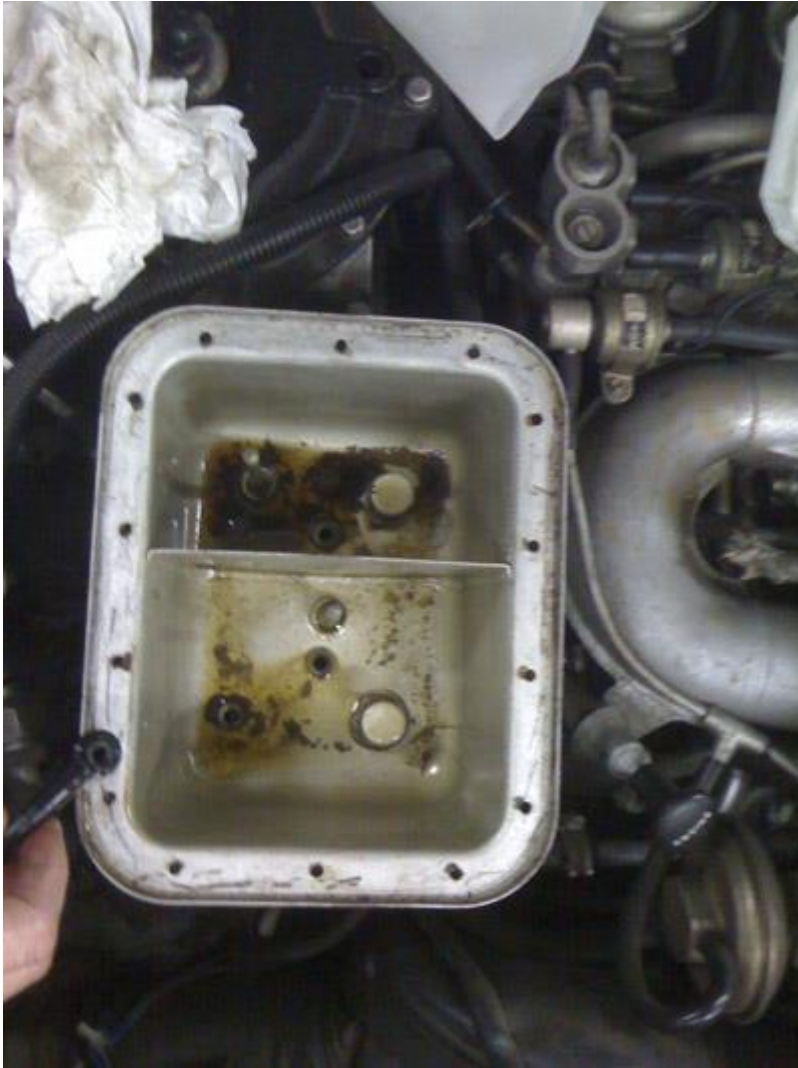
Bremsevæskereservoar med litt "grøt" dvs. gammel dekomponert RR 363
